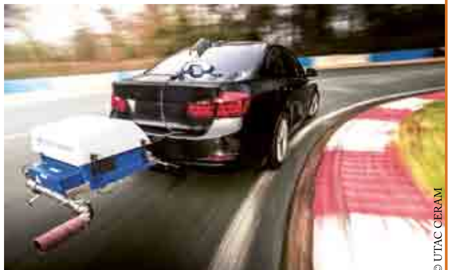
Laboratoire ambulant de mesure des gaz d'échappement d'une voiture
